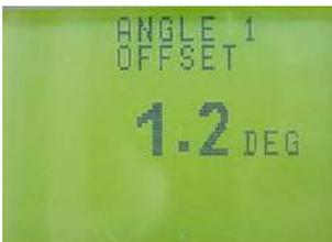
Presione el botón "SELECT" para entrar el ajustamiento; presionar el botón "C" cancelará el ajustamiento. La calibración del sensor ahora está completa.
