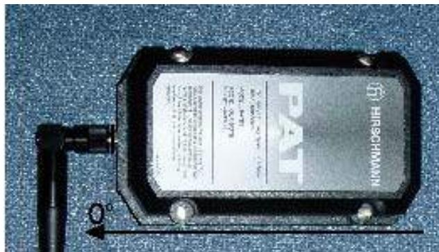
El sensor de ángulo se montará en el lado de la pluma para que como cambie el ángulo de la pluma, el sensor de ángulo puede girar como mostrado en las posiciones 0° (izquierda) y 90° (de arriba).
