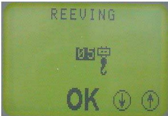
Use los botones "UP" y "DOWN" para ajustar el valor de las partes de la línea. .
