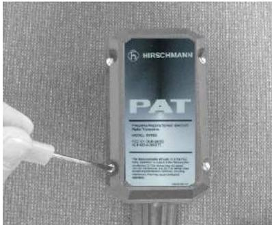
**DESATORNILLE LOS 4 TORNILLOS JUNTA**
