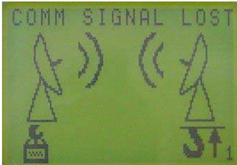
Esta pantalla muestra que hay un error en la comunicación entre el sensor/los sensores y la consola. El sensor que está en error se indica con el icono a la parte inferior de la pantalla. En el ejemplo, tanto el sensor de Carga como el interruptor A2B tienen error. Sólo se muestran los sensores que tienen algún error.
